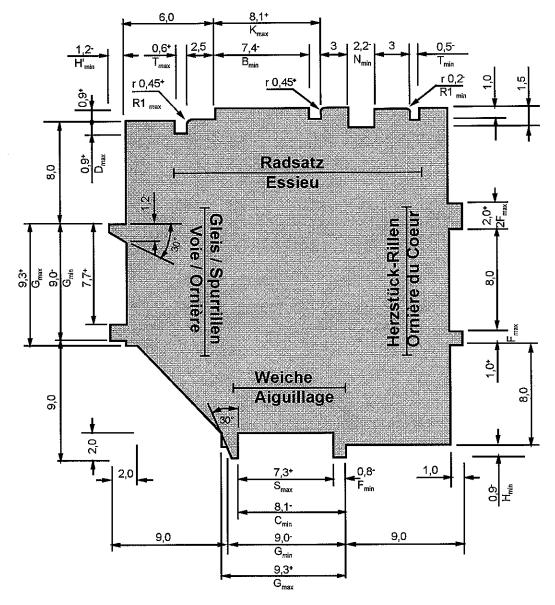
Tolérances du calibre: <sup>†</sup> signifie +0,03 - 0 <sup>\*</sup> signifie +0 - 0,03 Tolérances des cotes libres 0,5 Le calibre est accompagné par les soins de son fabricant d'un mode d'emploi afin d'utiliser celui-ci dans de bonnes conditions.
